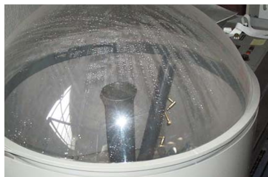
Saline fog chamber: ERICHSEN mod. 606 volume 400 litres.
