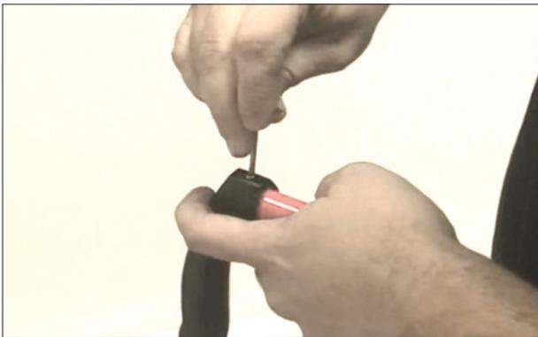
**16.** Зафиксировать нажимную балку в рычагах, используя ключ Аллена.
