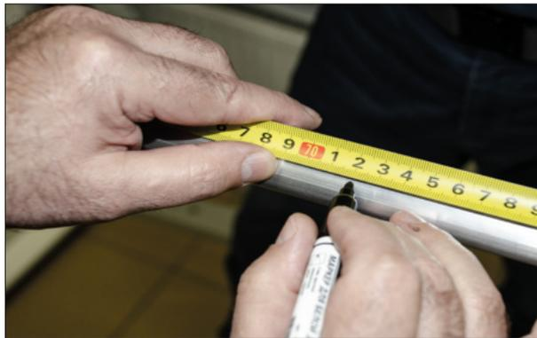
**15.** Прибавить к измеренному 30 мм и отрезать балку. В нашем случае длина балки составляет 720 мм. Отрезать балку.
