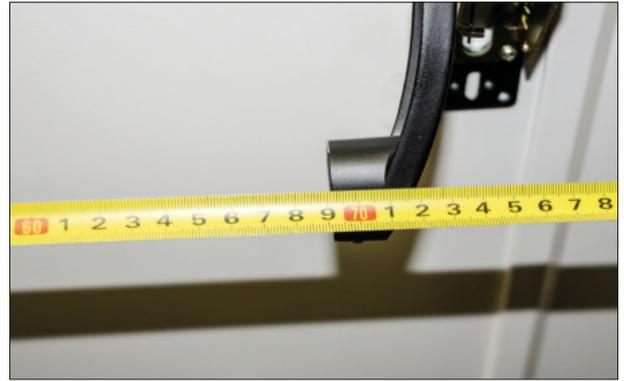
**14.** В нашем случае длина видимой части нажимной балки составляет 690 мм.
