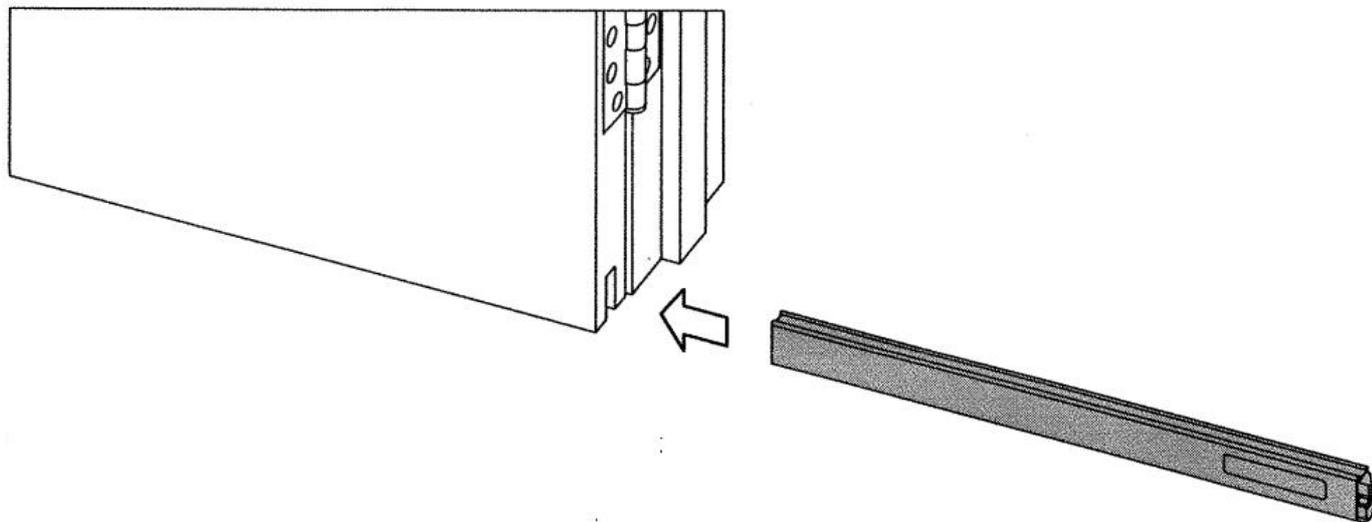
Зафиксировать порог с помощью монтажных кронштейнов, которые прикручиваются крепежными саморезами к торцевым сторонам двери.
