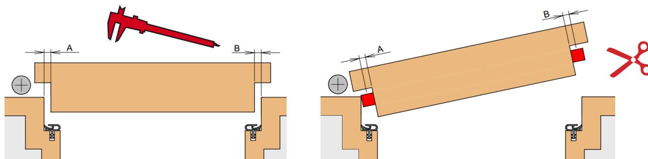
Установить порог в подготовленный паз на нижнем торце двери.
