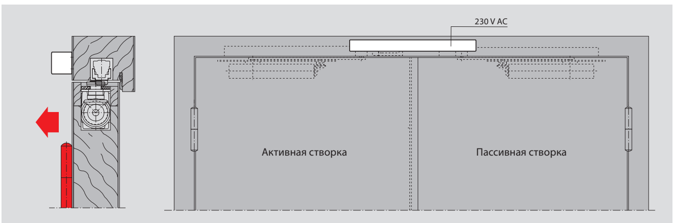
Центральный узел дымовой сигнализации RMZ со стороны петель вместе с ITS 96 GSR-EMF Пример: дверь DIN-L, дверь DIN-R в зеркальном отражении.
