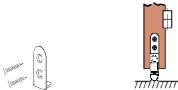
Прикрепите запорную планку к дверной коробке крепежным саморезом из комплекта.
