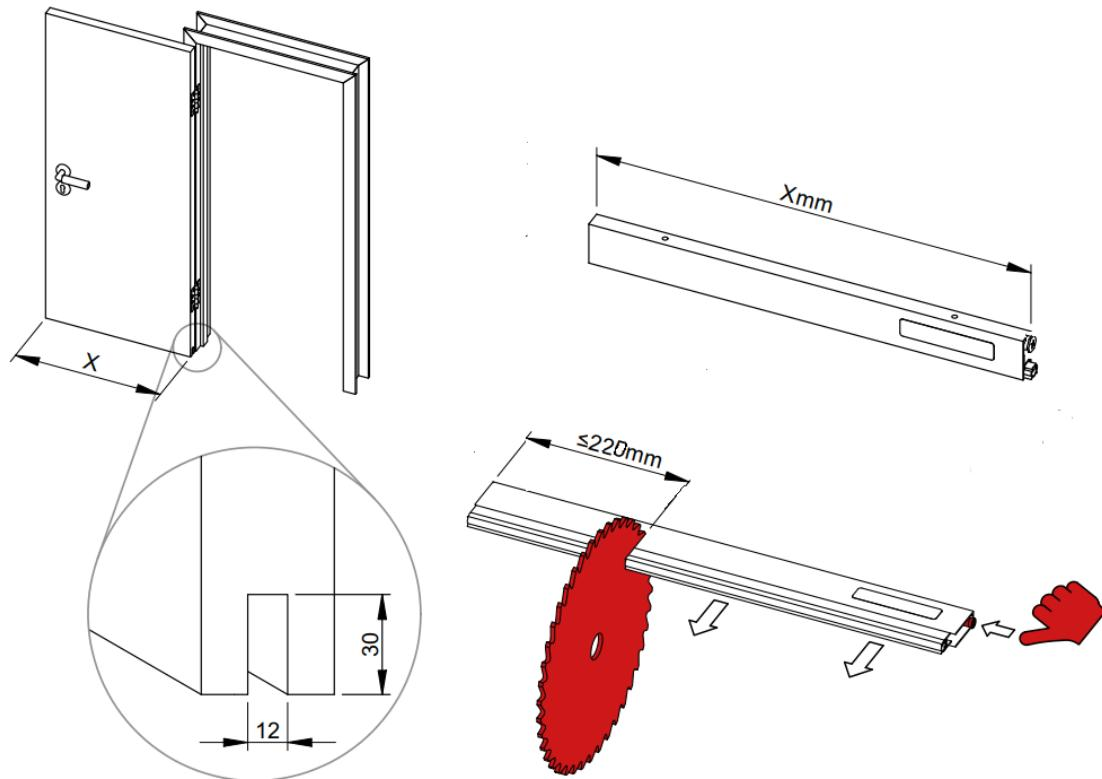
Извлечь уплотнитель из внутреннего зажимного профиля (внутренний зажимной профиль можно извлечь из направляющего профиля). Отпилить порог до нужной длины (отпилить не более 220 мм). Внутренний зажимной профиль должен быть короче направляющего профиля на 3мм. Зачистить напильником торцевую сторону отпила. Вставить уплотнитель в зажимной профиль. Отрезать уплотнитель до нужного размера, но оставить запас с каждой стороны (размер А, В).
