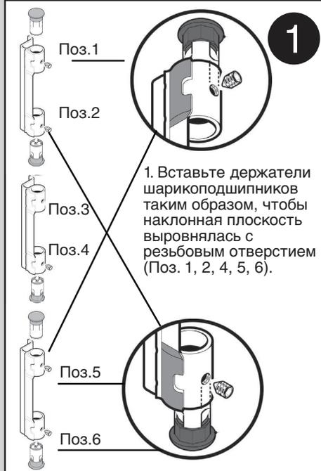
1. Вставьте держатели шарикоподшипников таким образом, чтобы наклонная плоскость выровнялась с резьбовым отверстием (Поз. 1, 2, 4, 5, 6).
