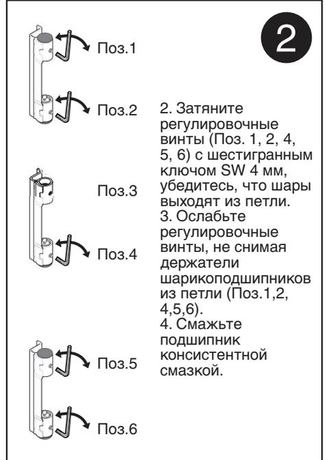
2. Затяните регулировочные винты (Поз. 1, 2, 4, 5, 6) с шестигранным ключом SW 4 мм, убедитесь, что шары выходят из петли.
