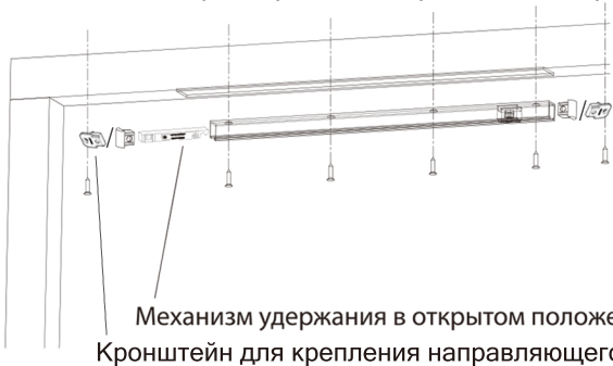
Рис. 2. Установить и зафиксировать направляющий профиль тяги
