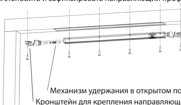
Рис. 2. Установить и зафиксировать направляющий профиль тяги
