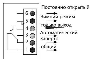
Описание разъемов ключевого выключателя автоматической двери Подключается к колодке контроллера J4 .
