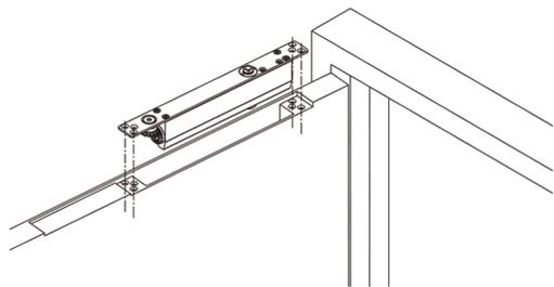
**Рис. 2.** Установить и зафиксировать направляющий профиль тяги
